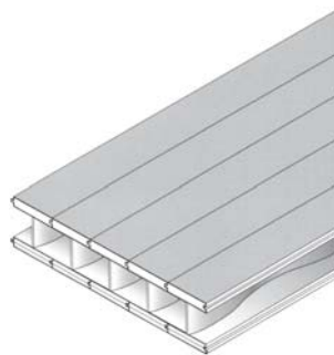
Fig. 34: Wellsteg hollow element
